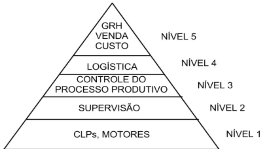
Nível 1 - Máquinas, CLPs, transdutores, motores, válvulas atuadores
